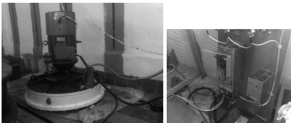
Рисунок 2. НКЭ (4 МДж) с мотор-генератором 22 кВт и инвертор-преобразователь.
